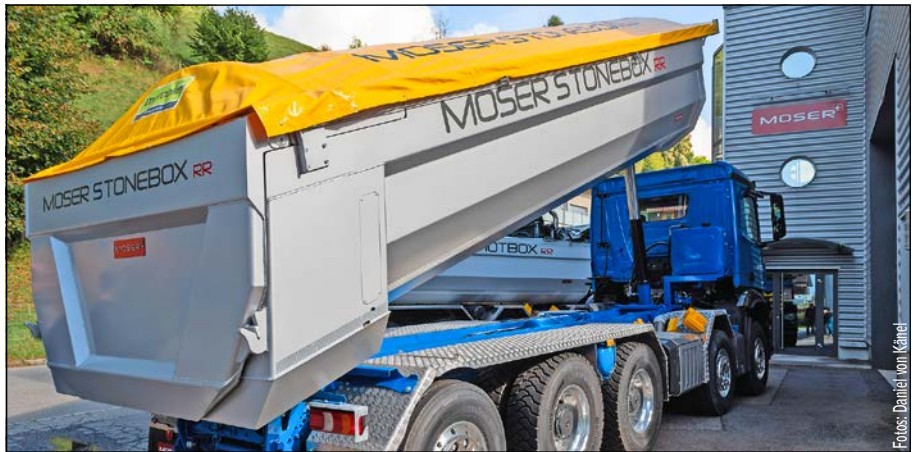
Stonebox RR: Erhältlich als nutzlastoptimierter oder schlammDICHTER Rückwärtskipper sowie mit einer hochfesten Kippmulde.
